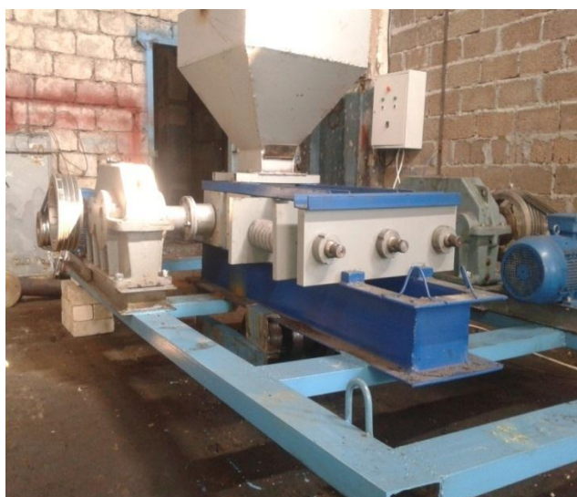
Рис. 1. Пресс-валковый измельчитель с устройством для дезагломерации материалов: а) схема, б) опытная установка
